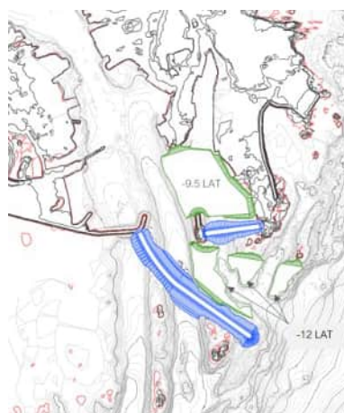
Figur 2-5 Alternativ 5: Innseiling fra øst. Mudring til -9.5 LAT i indre del, og -12 LAT i innseiling.
