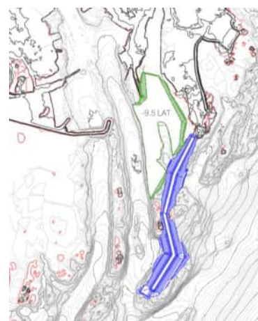
Alternativ 3: Innseiling fra sør. Molo forlenget ut til Seiklakkflua. Mudring til -9.5m LAT i grønt.
