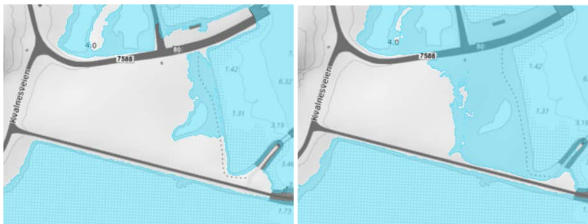
Figur 8: Omfang av 200-års stormflo med dagnes havnivå i figur til venstre og med havnivå i 2100 med anbefalte klimapåslag til høyre.
