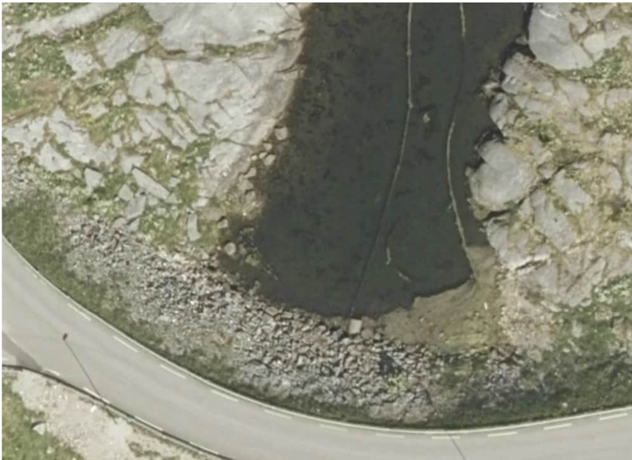
Figur 4: Historisk flyfoto (Værøy 2017) som viser vannledning (til venstre) og overvannsrør som krysser deponiområdet. Ledning til høyre har ukjent opphav og funksjon.
