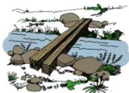
KLOPP. Enkel klopp av to planker over bekk.
